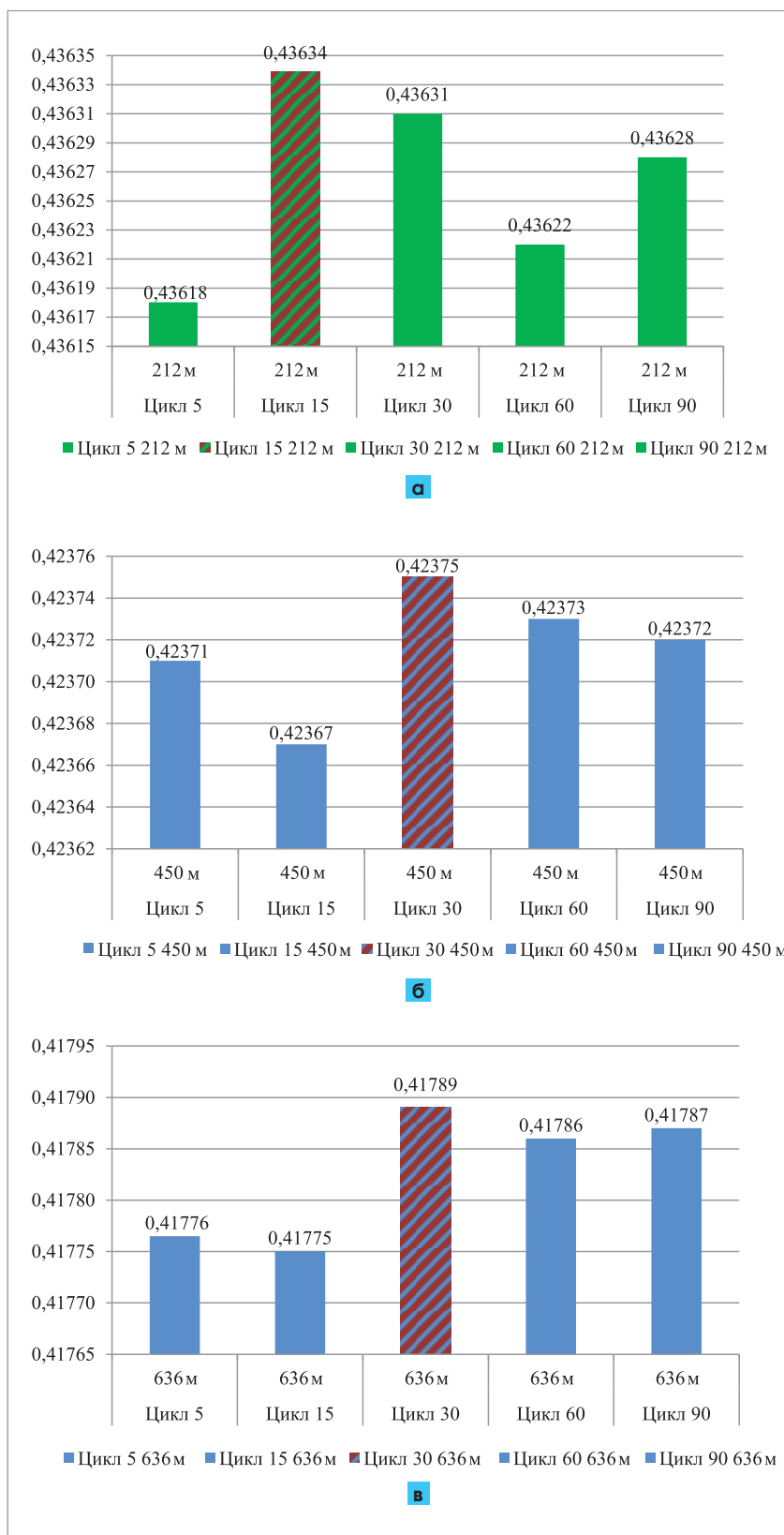
Рис. 7. КИН при различных вариантах полупериода закачки. Размеры элемента заводнения 212 м (а), 450 м (б), 636 м (в)
