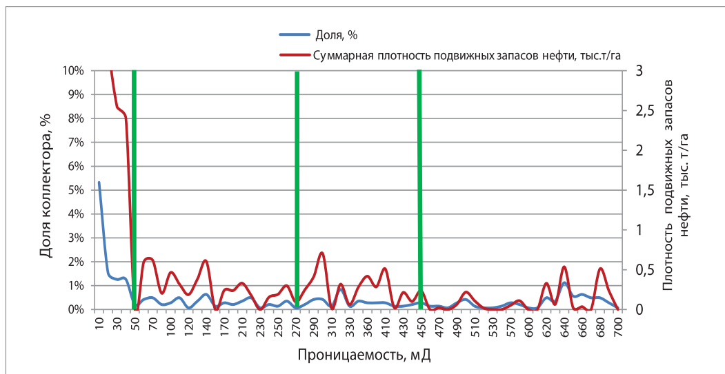
Рис. 2. Распределение доли коллектора и плотности подвижных запасов нефти в зависимости от значений абсолютной проницаемости продуктивных интервалов по скважинам участка № 1
