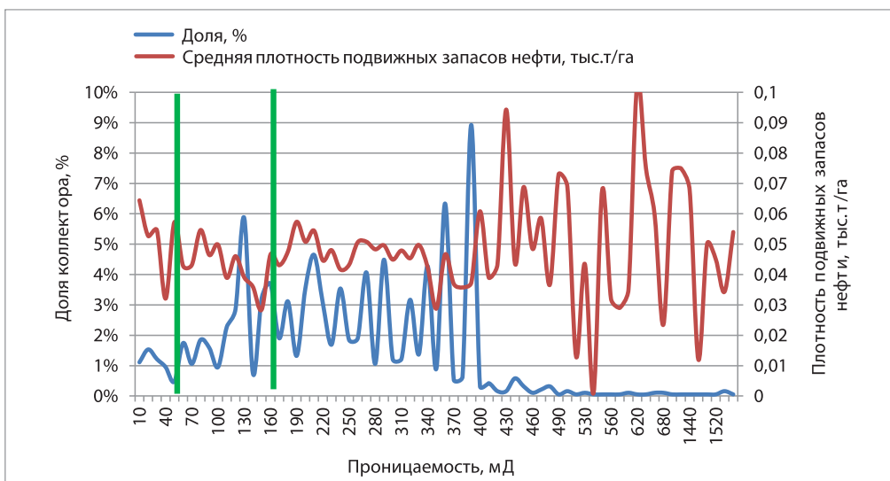
Рис. 7. Распределение доли коллектора и плотности подвижных запасов нефти в зависимости от значений абсолютной проницаемости продуктивных интервалов по скважинам участка № 3
